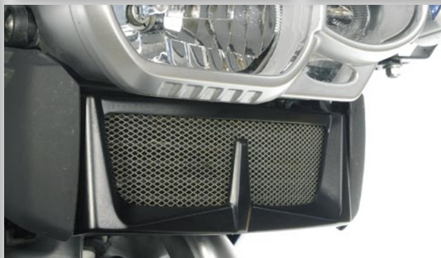
K 1200 R: telaio in plastica ABS termoformato.
