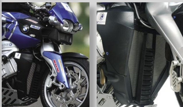
Griglia Radiatore Acqua: retina in acciaio Inox e mascherina in alluminio
